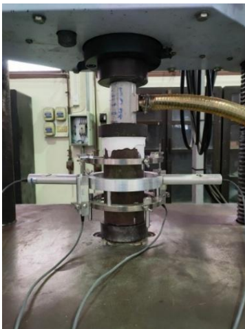
รูปที่ 4 การจัดวางอุปกรณ์การทดสอบของตัวอย่างจีโอพอลิเมอร์คอนกรีต
