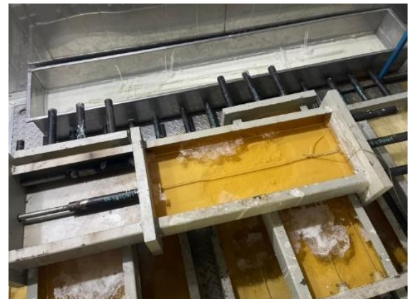
รูปที่ 8 การแช่อัลคาไลน์ของชิ้นทดสอบในสถานะที่มีแรงกระทำและไม่มีแรงกระทำ
