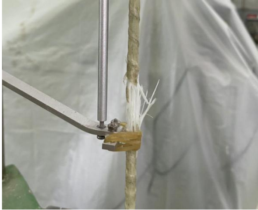
รูปที่ 11 ลักษณะการวิบัติของการทดสอบความต้านแรงดึงตามแนวยาว
