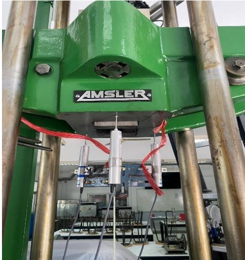
รูปที่ 6 การติดตั้งชิ้นทดสอบความแข็งแรงในการอัดเหนียว
