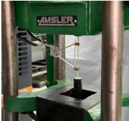
รูปที่ 4 การติดตั้งชิ้นทดสอบหาความต้านแรงดึงตามแนวยาว
