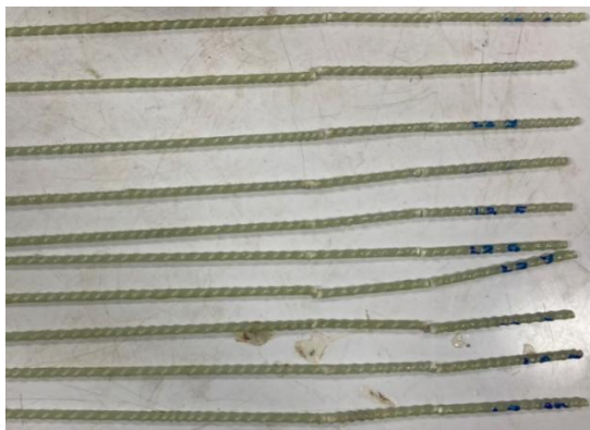
รูปที่ 14 ลักษณะการวิบัติของการทดสอบความต้านทานแรงเฉือน
