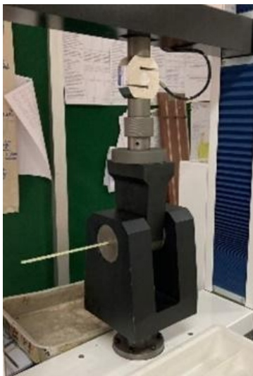
รูปที่ 7 การติดตั้งเครื่องมือทดสอบความต้านทานแรงเฉือนตามขวาง
