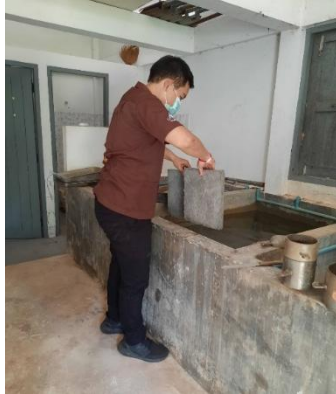
รูปที่ 5 ทดสอบค่าการดูดซึมน้ำตามมาตรฐานแช่น้ำระยะเวลา 24 ชั่วโมง
