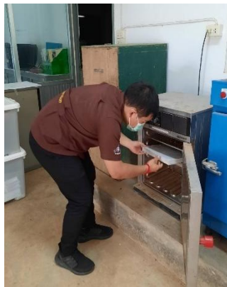
รูปที่ 6 ทดสอบค่าการดูดซึมน้ำตามมาตรฐานอบเป็นระยะเวลา 24 ชั่วโมง
