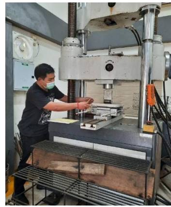
รูปที่ 4 การทดสอบกำลังต้านทานแรงดัดตามขวางด้วยเครื่อง UTM
