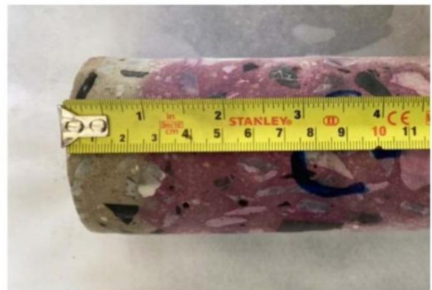
รูปที่ 4 - 2 การทดสอบหาความลึกคาร์บอนเนชัน ของสะพานข้ามแยกบายพาสบ้านบึง
