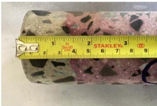
รูปที่ 4 - 2 การทดสอบหาความลึกคาร์บอนเนชัน ของสะพานข้ามแยกบายพาสบ้านบึง
