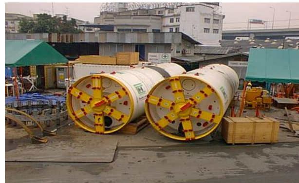
รูปที่ 3 หัวเจาะ EPB : Herrenknecht
