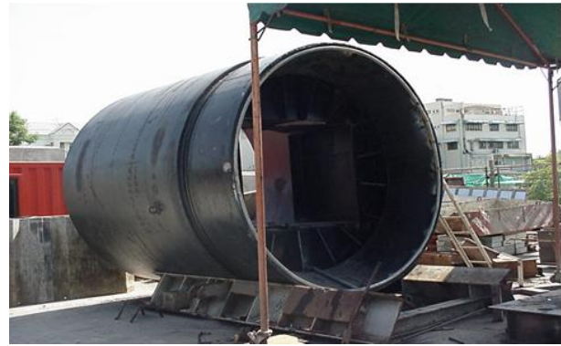
รูปที่ 2 หัวเจาะ Open Shield (ITD-MAKE)
