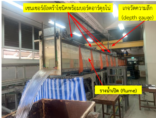
(ข) ตำแหน่งติดตั้งเซนเซอร์อัลตราโซนิกและบอร์ดอาร์ดูโน
