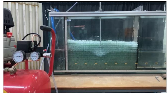
รูปที่ 3.4 การทดสอบก่อนใช้ Air injection pressure 2 bar
