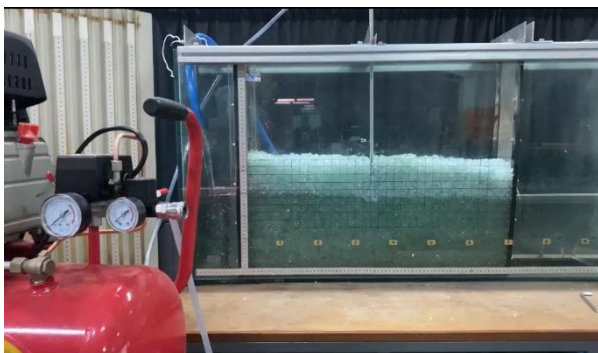
รูปที่ 3.2 การทดสอบก่อนใช้ Air injection pressure 0 bar(ก่อนปล่อย Air injection)
