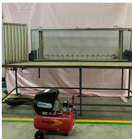
รูปที่ 2.5 เครื่อง seepage tank และปั๊มลม
