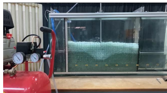
รูปที่ 3.6 การทดสอบก่อนใช้ Air injection pressure 4 bar
