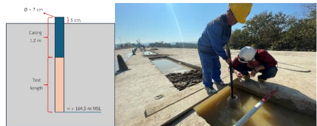
รูปที่ 9 ลักษณะการทดสอบค่าความทึบน้ำในสนาม
