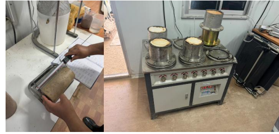
รูปที่ 8 การทดสอบหน่วยน้ำหนักและค่าความทึบน้ำในห้องปฏิบัติการ
