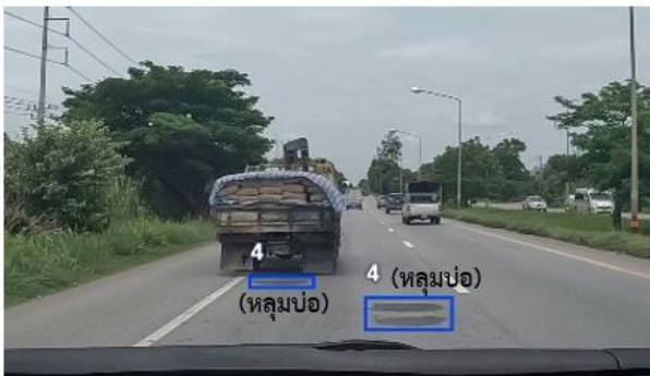
รูปที่ 8 การระบุประเภทความเสียหายในภาพด้วยเครื่องมือ RoboFlow
