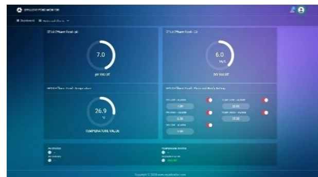
รูปที่ 9 ระบบ IOT ตรวจสอบคุณภาพน้ำเสียเบื้องต้น
