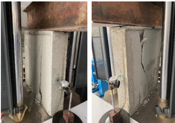
รูปที่ 2 การทดสอบผนังอิฐก่อ
