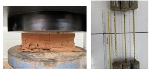
รูปที่ 1 อิฐมวล ขนาด 60 x 60 x 150 มม. และวัสดุเสริมแรง GFRP ชนิดเส้น ขนาด 6 มม.
