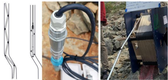
รูปที่ 7 เครื่องมือวัดการเคลื่อนตัวแนวราบ
