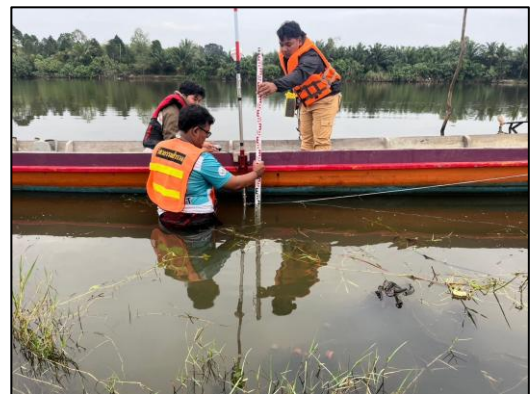
รูปที่ 6 การติดตั้งเทอร์โมมิเตอร์วัดอุณหภูมิผิวน้ำ กับตัวทรานสดิวเซอร์ และก่อนที่จะทำการลงสำรวจ ต้องมีการวัดสอบอุปกรณ์กับไม้เมตร หรือไม้ระดับ (Staff) ก่อนทุกครั้ง เพื่อเป็นการตรวจสอบระดับความลึกเบื้องต้น
