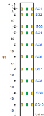
รูปที่ 1 รายละเอียดเสาค้ำจ้งจำลองและตำแหน่ง Strain gauge บนเสาค้ำจ้งจำลอง
