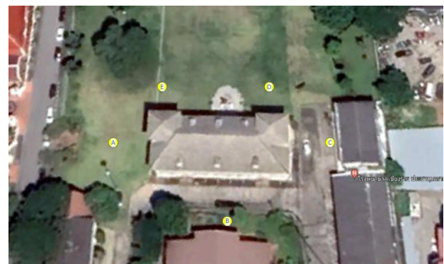
รูปที่ 2 ตำแหน่งควบคุมภาคพื้นดิน (BM) รอบอาคารศาลากลางจังหวัดเชียงราย หลังเก่า
