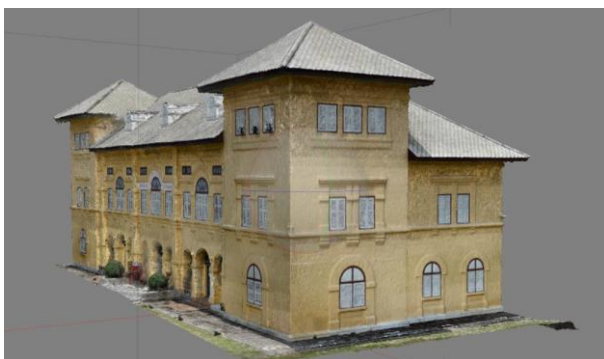
รูปที่ 4 แบบจำลองอาคาร 3 มิติ GSD = 0.400 cm/pix แบบ GCP 12 จุด
