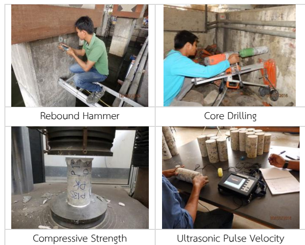
รูปที่ 11 การทดสอบคุณสมบัติคอนกรีตโครงสร้างสะพาน
