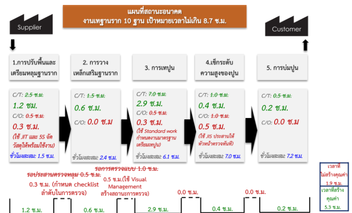
รูปที่ 5 Future State Map ในการปรับกระบวนการงานฐานราก 10 ฐาน ให้เหลือไม่เกิน 8.7 ชั่วโมง
