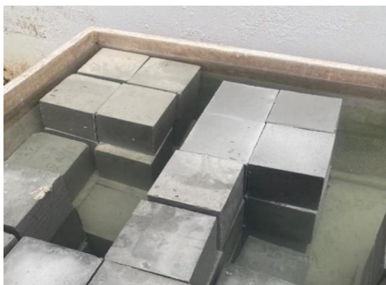
รูปที่ 2 คอนกรีตผสมเล้าหนักจากไม้ยางพาราแทนที่มวลรวมละเอียด
