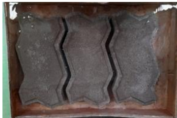
รูปที่ 9 การทดสอบการดูดกลืนน้ำ (Water Absorption 72 hr.)
