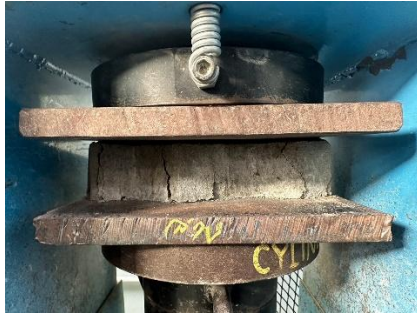
รูปที่ 8 การทดสอบกำลังต้านทานแรงอัด
