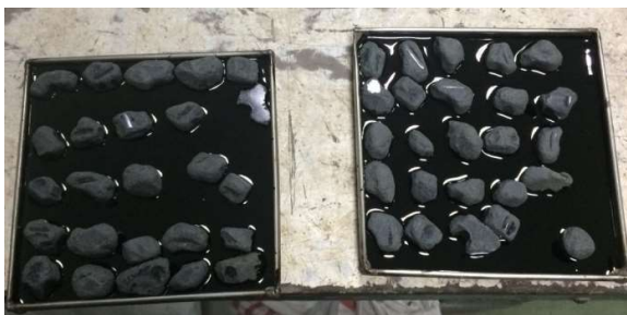
รูปที่ 6 เบกาไลต์ที่เกาะบนผิวแอสฟัลติก
