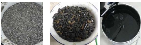
รูปที่ 4 หินคลุก เบกาไลต์ และ แอสฟัลติกซีเมนต์ AC 60-70
