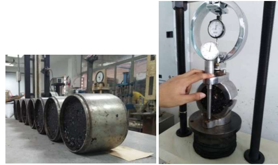
รูปที่ 5 ตัวอย่างแอสฟัลติกคอนกรีต และการทดสอบ Marshall
