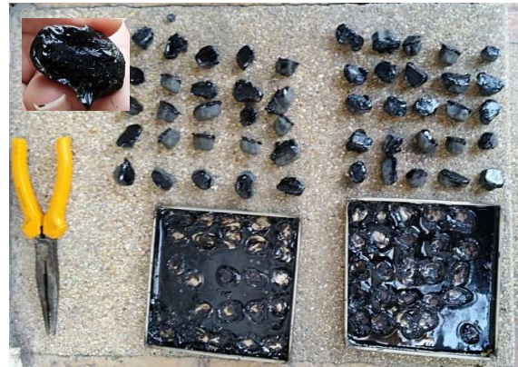
รูปที่ 7 การยึดเกาะของยางจากการทำ Stripping
