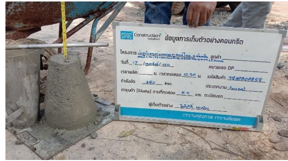
รูปที่ 13 แสดงทดสอบค่าการยุบตัวของคอนกรีต
