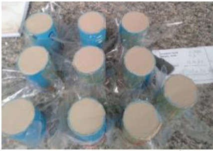
รูปที่ 4 หล่อตัวอย่างสำหรับใส่ตัวอย่างและบ่ม ที่อุณหภูมิห้อง
