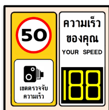
รูปที่ 15 ป้ายบอกความเร็ว (Your Speed Sign)
