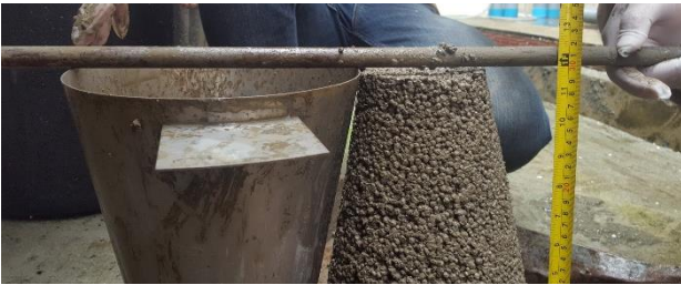
รูปที่ 5 การทดสอบความชันเหลวของคอนกรีต (Slum Test)
