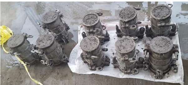
รูปที่ 6 การเก็บตัวอย่างทดสอบขนาดมาตรฐาน ขนาดเส้นผ่านศูนย์กลาง 100 มม. สูง 200 มม.
