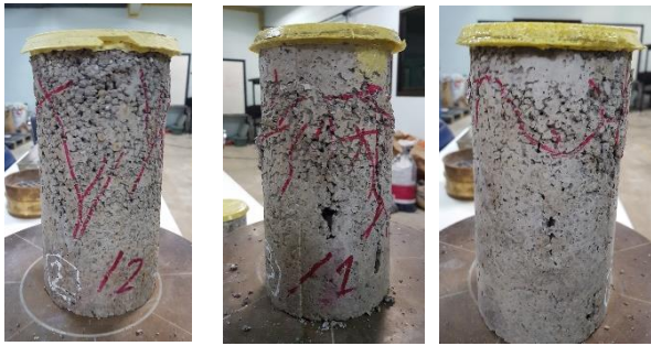
รูปที่ 12 การวิบัติเนื่องจากแรงอัดของตัวอย่างมาตรฐาน
