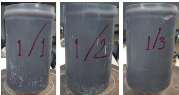
รูปที่ 13 การวิบัติเนื่องจากแรงอัดของตัวอย่างก่อนรับแรงน้ำหนักเบา
