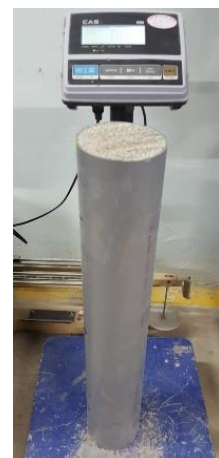
รูปที่ 8 ตัวอย่างท่อนรับแรงน้ำหนักเบาสำหรับทดสอบในห้องปฏิบัติการความสูง สำหรับ (ก) ทดสอบกำลังรับอัด และ (ข) ทดสอบกำลังรับแรงดัด
