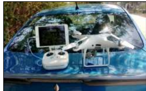
รูปที่ 9 อากาศยานไร้คนขับยี่ห้อ DJI รุ่น Phantom 4 pro V 2
