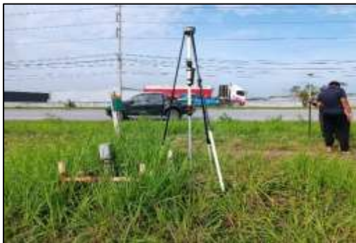
รูปที่ 7 การรังวัดค่าพิกัด GCPs และ CPs ส่วนของการตั้งที่สถานีฐานหลัก
