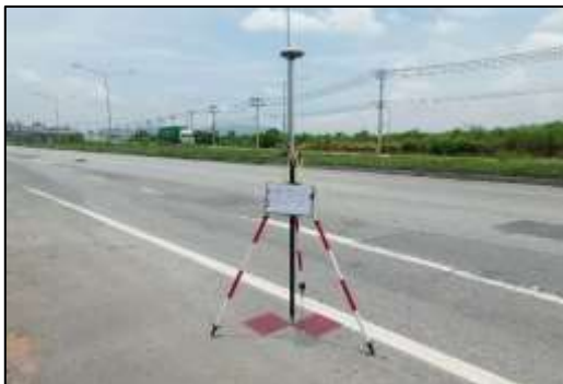
รูปที่ 8 การรังวัดค่าพิกัด GCPs โดยวิธีการแบบ RTK ส่วนของ Rover
