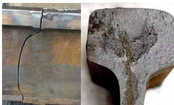
รูปที่ 5 ที่ผิวมีจุดชำรุดด้านบนหัวรางขอบด้านข้าง (สนข,2561)
