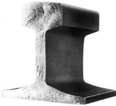
รูปที่ 10 Code 200 รอยหักตามขวาง (Transverse Break)
