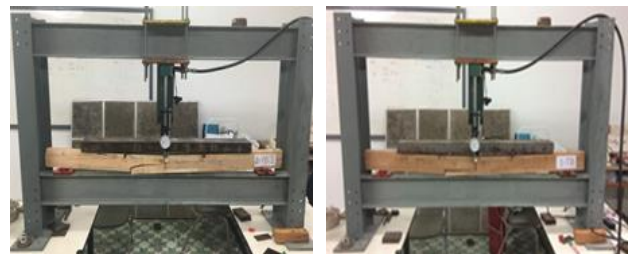
รูปที่ 16 การวิบัติของคานไม้ประกอบจากไม้ยางพารา
