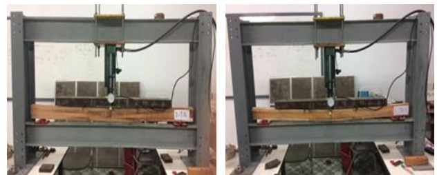
รูปที่ 17 การวิบัติของคานไม้ประกอบจากไม้สะเดาเทียม
