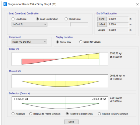
รูปที่ 3 คานโค้งตัวสูงสุดของโครงสร้างเป็นคอนกรีตเสริมเหล็ก พื้นหล่อในที่ และผนังก่ออิฐ
