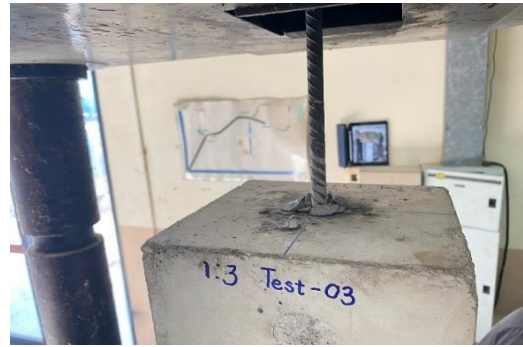
รูปที่ 6 ลักษณะการวิบัติของชิ้นตัวอย่างทดสอบที่ 3
