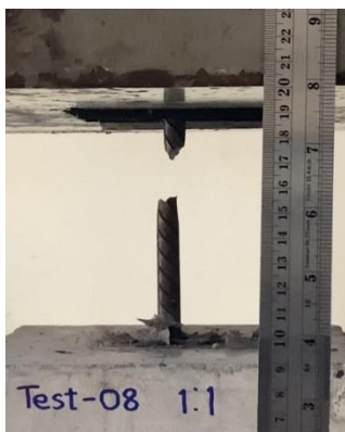
รูปที่ 10 ลักษณะการวิบัติของชิ้นตัวอย่างทดสอบที่ 8
