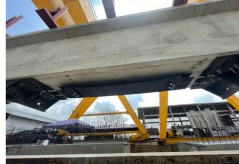
รูปที่ 7 ชุดแถบยางพาราบริเวณด้านล่างของคานทดสอบ
