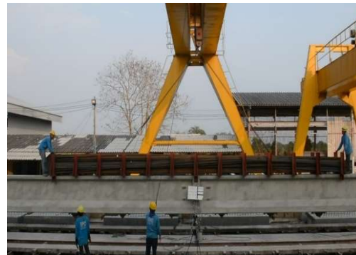
(จ) การทดสอบคานคอนกรีตอัดแรงแบบพลวัต
