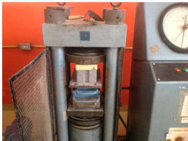
รูปที่ 9 การทดสอบกำลังอัดของบล็อกประสานมวลเบาจากฟูนหินปูนผสมเศษกระดาศ
