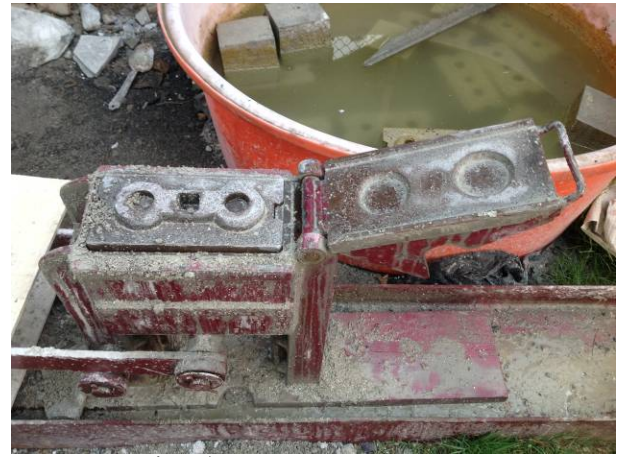
รูปที่ 5 เครื่องอัดรูปบล็อกประสานแบบมือโยก
