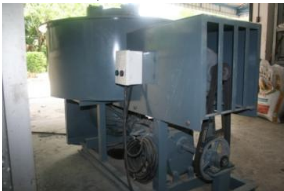
รูปที่ 4 เครื่องผสมคอนกรีต
