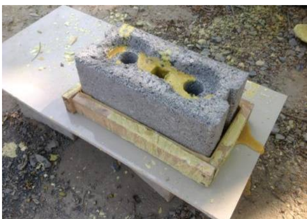
รูปที่ 8 บล็อกประสานมวลเบาจากฟูนหินปูนผสมเศษกระดาศที่เคลือบผิวหน้าด้วยกัมมะถันสำหรับทดสอบกำลังอัด
