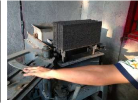
(ข) ขึ้นรูปคอนกรีตบล็อกด้วยเครื่องอัดแบบกึ่งอัตโนมัติ
