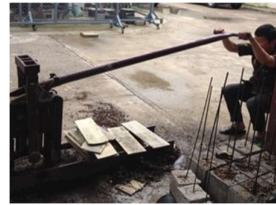
(ค) ขึ้นรูปอิฐบล็อกประสานด้วยเครื่องอัดแบบมือโยก
