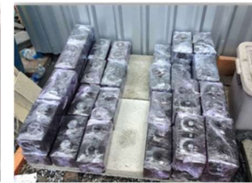
(ง) บ่มตัวอย่างโดยการพรมน้ำและห่อด้วยแผ่นพลาสติก
