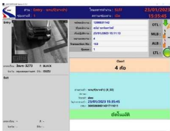
รูปที่ 9 กรณีมีบัตร Easy Pass หรือ M-Pass ผ่านช่องทางขาเข้า (SLFF)
