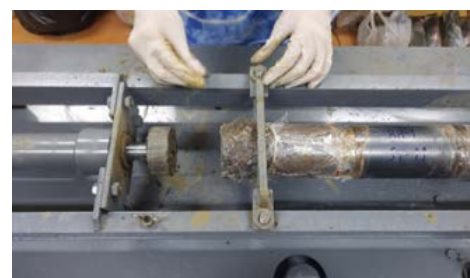
รูปที่ 5 การติดตั้งกระบอกบางเพื่อทำการดันดิน
