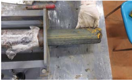
รูปที่ 7 ตัวอย่างดินที่ดันออกมาจากเครื่องดันดิน
