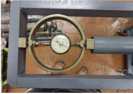
รูปที่ 6 วงแหวนวัดแรงดันที่ใช้ในการดันตัวอย่างดินจากกระบอกบาง
