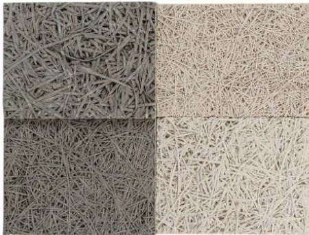
รูปที่ 1 ลักษณะของแผ่นซีเมนต์บอร์ดผสมเส้นใยไม้ (Wood-wool cement board)
