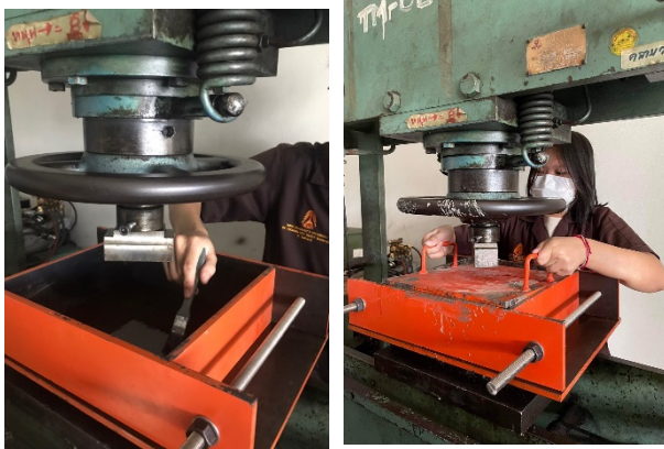
รูปที่ 7 การติดตั้งชุดเครื่องมือที่พัฒนาขึ้นกับเครื่องอัดไฮดรอลิกขนาด 30 ตัน
