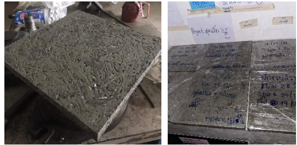
รูปที่ 8 การบ่มตัวอย่างแผ่นที่จะดำเนินการทดสอบ
