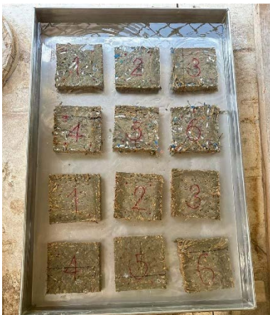
รูปที่ 10 การทดสอบการดูดซึมน้ำของแผ่นซีเมนต์บอร์ด
