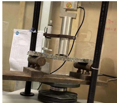
รูปที่ 9 การติดตั้งแผ่นตัวอย่างสำหรับทดสอบมอดูลัสแตกหัก แผ่นซีเมนต์บอร์ด
