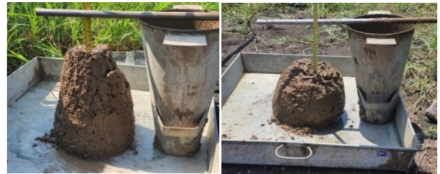
รูปที่ 3 Slump ของ activated fly ash concrete ที่หน้าด่านซึ่ง (ซ้าย) 10 ซม ก่อนเติม NaOH (ขวา) 18 ซม หลังเติม NaOH
