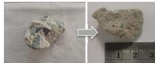
รูปที่ 4 เศษคอนกรีตบด (RCAC) ที่มีขนาดใหญ่มากที่สุด 25 มม.
