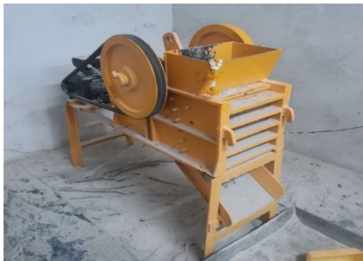
รูปที่ 1 เครื่องบดคอนกรีต
