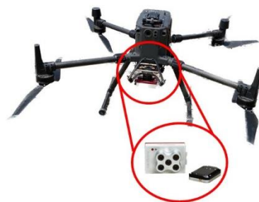
รูปที่ 6 DJI Matrice 300 RTK พร้อมติดตั้งกล้องมัลติสเปกตรัมยี่ห้อ MicaSense RedEdge-MX™
