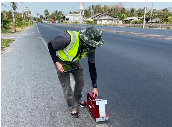
รูป 7 เก็บข้อมูลค่าการสะท้อนแสงของเส้นจราจร ด้วยเครื่องมือวัดค่าการสะท้อนแสงของสีตีเส้น (Retroreflectometer)
