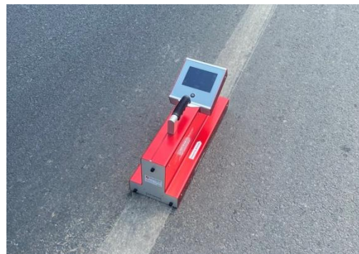
รูปที่ 5 เครื่องมือวัดค่าการสะท้อนแสงของสีตีเส้น (Retroreflectometer)
