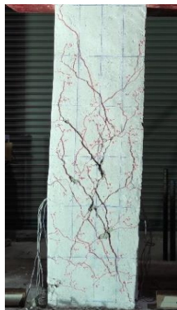
รูปที่ 12 คอนกรีตเริ่มมีการหลุดร่อนเกิดขึ้นของเสาตัวอย่าง C0 ที่อัตราการเคลื่อนที่ 2.50 %
