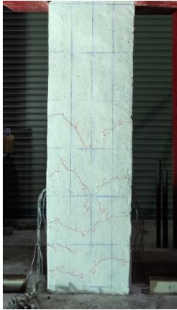
รูปที่ 11 รอยแตกกร้าวของเสาตัวอย่าง C0 ที่อัตราการเคลื่อนที่ 1.00 %
