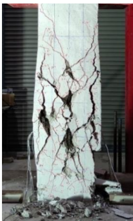
รูปที่ 13 การวิบัติเมื่อสิ้นสุดการทดสอบของเสาตัวอย่าง C0
