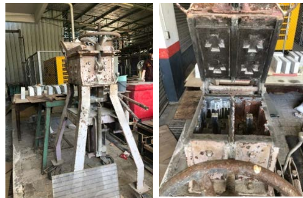
รูปที่ 7 เครื่องอัดอิฐบล็อกประสานแบบไฮดรอลิก
