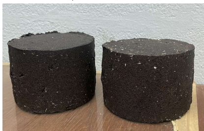
รูปที่ 4 ก้อนตัวอย่างสำหรับการทดสอบมาร์แชลล์
