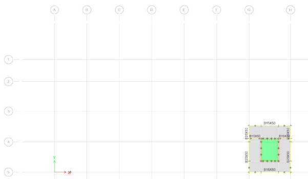
รูปที่ 9 ผังโครงสร้างพื้นชั้นหลังคาคลุมห้องลิฟท์
