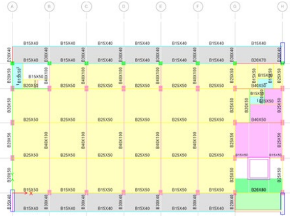
รูปที่ 17 ผังโครงสร้างพื้นชั้นที่ 4 ที่ทำการปรับปรุง
