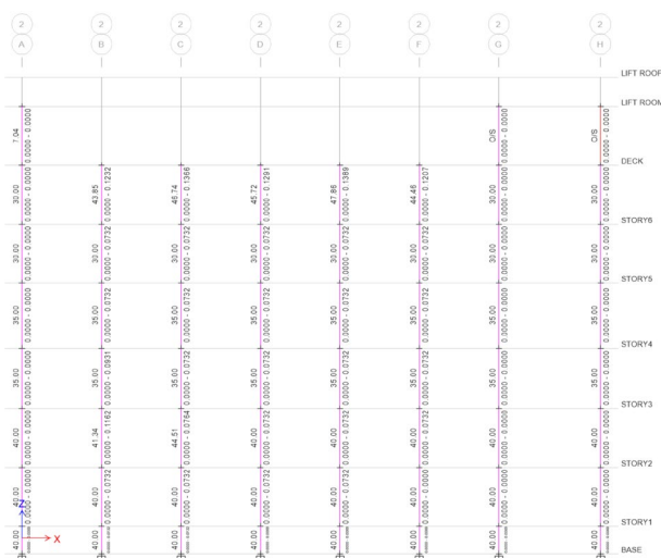
รูปที่ 11 ปริมาณเหล็กเสริมหลักและเหล็กปลอกที่ต้องการในเสา Grid Line 2
