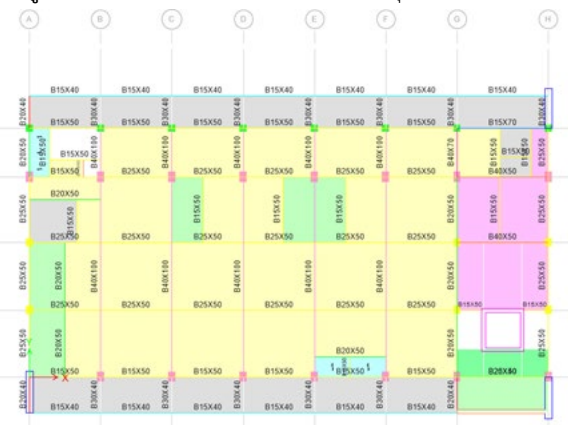
รูปที่ 18 ผังโครงสร้างพื้นชั้นที่ 5 ที่ทำการปรับปรุง
