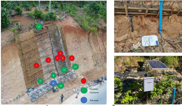
รูปที่ 11 ตำแหน่งและการติดตั้งอุปกรณ์วัด
