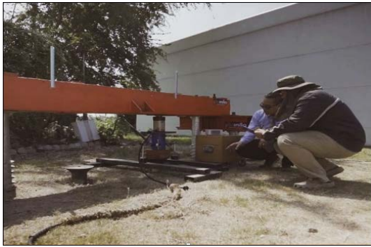
รูปที่ 6 การทดสอบน้ำหนักบรรทุกของเข็มเหล็กด้วยวิธีสถิตยศาสตร์
