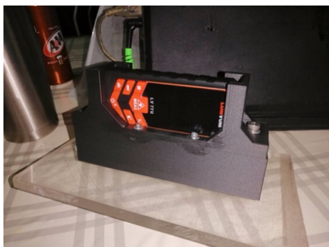
รูปที่ 10 เครื่องวัดระยะด้วยแสงเลเซอร์แบบมือถือรุ่นที่สอง วัดมุมได้ด้วยตนเอง โดยไม่มีงานองศา
