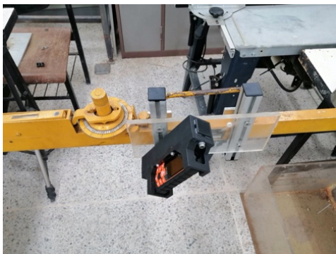
รูปที่ 9 เครื่องวัดระยะด้วยแสงเลเซอร์แบบมือถือรุ่นแรก แบบมีงานองศา
