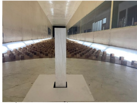
รูปที่ 3 แบบจำลองอาคารที่ใช้ในการทดสอบด้วยวิธี HFFB
