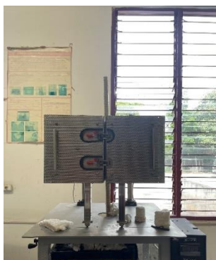
รูปที่ 2 การทดสอบการให้ความร้อนแก่แท่งพอลิเมอร์เสริมใยแก้ว
