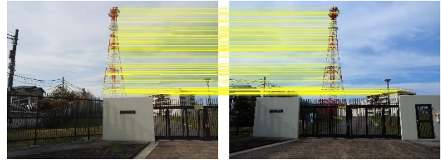
รูปที่ 2 การเชื่อมโยงจุด ขอบ และมุมที่เหมือนกันในสภาพแวดล้อมจริง แต่อยู่ต่างภาพถ่ายกัน
