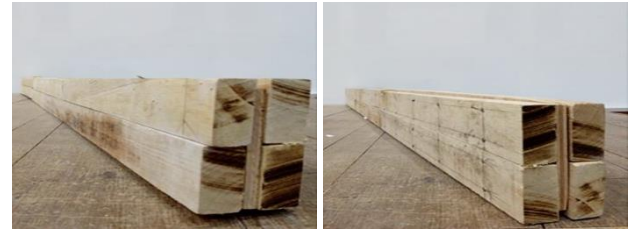
รูปที่ 6 ตัวอย่างรูปแบบการประกอบเป็นคานไม้ประกอบ
