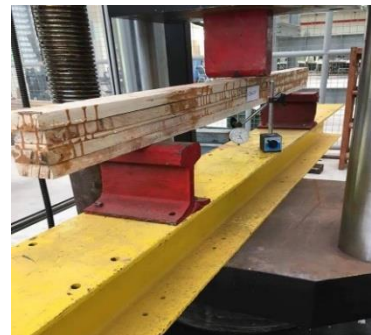
รูปที่ 7 ตัวอย่างการทดสอบกำลังต้านทานแรงดัดของคานไม้ประกอบ
