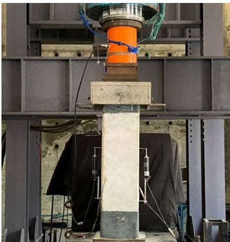
รูปที่ 9 การติดตั้งเครื่องมือทดสอบเสาตัวอย่าง
